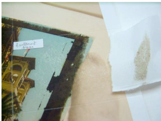
III. 2 : Tests 2007, tirages jet d'encre sur papiers pur coton, réactions au frottement avec un papier rugueux.
