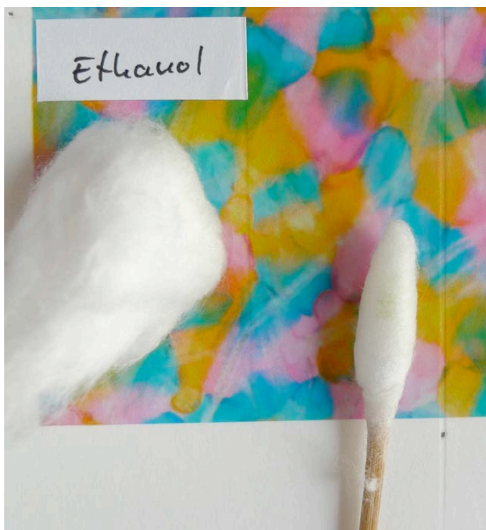
Illustration 18 : effet de l'éthanol + frottement sur un papier pur coton. Très légère perte de pigments visible sur le bâtonnet de coton. (photo F. Ploye)
