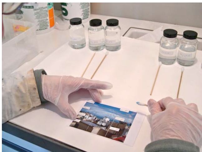
III. 9 : Tests 2008, application d'un solvant avec un bâtonnet de coton sur un échantillon. Le coton est bleu.
