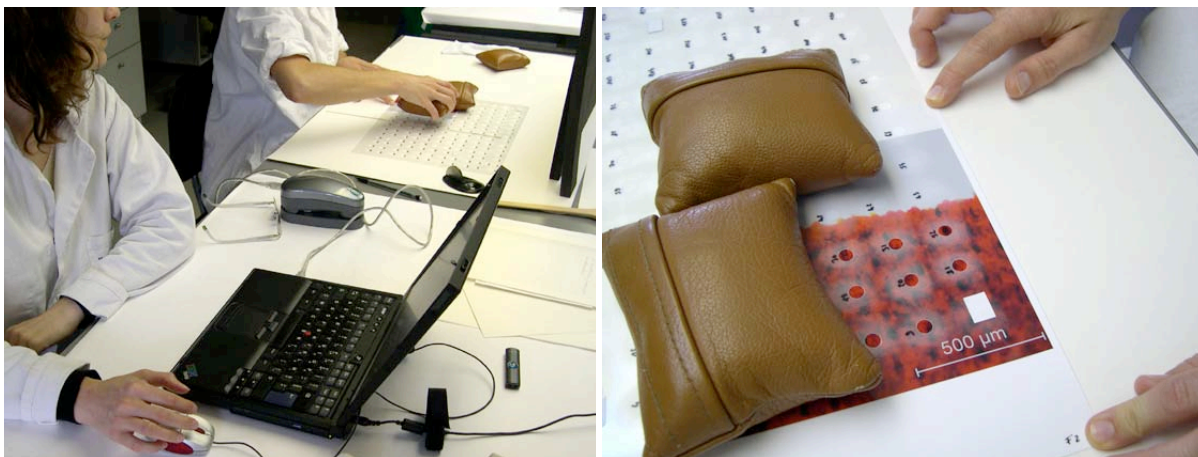
Illustrations 3 et 4 : colorimétries réalisées à l'Arcep sur les échantillons avant et après traitement d'humidification / mise à plat. (photo : F. Ploye)
