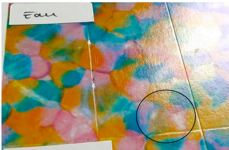
Illustration 15 : effet de l'eau + frottement sur le papier baryté F4 (perte de couleur). Les autres échantillons réagissent bien à un léger nettoyage de ce type. (photo F. Ploye)
