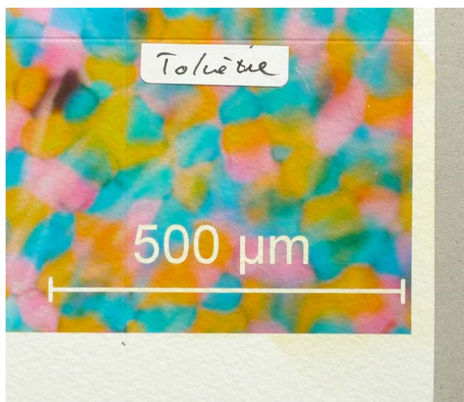
Illustration 20 : l'effet du toluène sur un papier pur coton, bien que moins destructif que sur un papier baryté, provoque des auréoles jaunes (diffusion / solubilisation de certaines encres). (photo F. Ploye)
