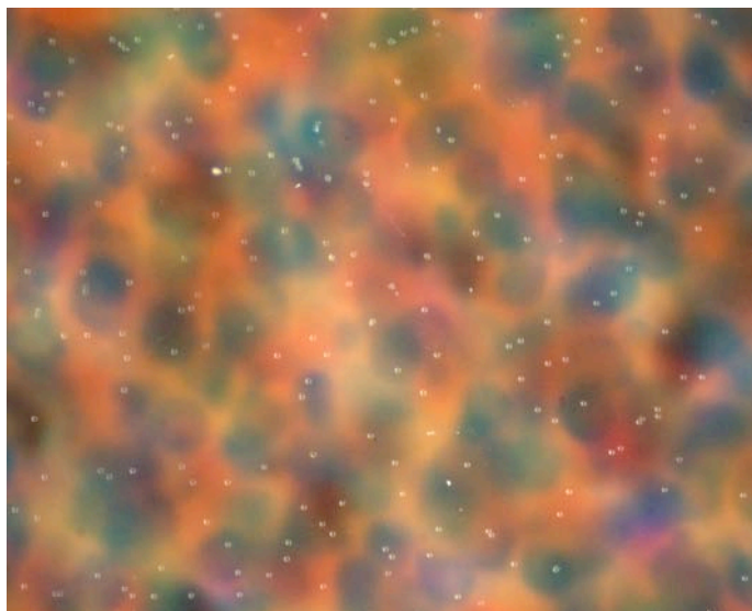
Illustration 42 : colorants sur papier RC brillant. Les gouttes semblent un peu « lointaines » dans la couche réceptrice en polymère. Grossissement 75x. (photos F. Ploye/lnp)
