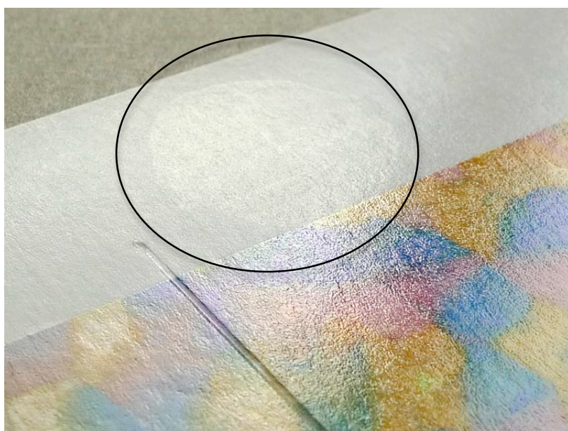
Illustration 16 : effet de l'eau + frottement dans une zone non encrée d'un papier baryté (modification de l'aspect du surface, gain de brillance). (photo F. Ploye)
