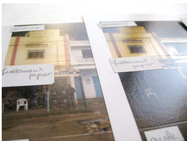
III. 11 : Tests 2008, action du frottement d'un papier rugueux sur deux tirages jet d'encre pigmentaire sur papier baryté. Pas d'abrasion visibles à l'œil nu.
