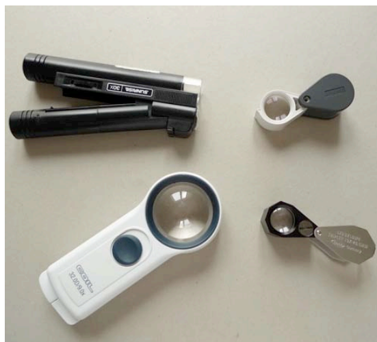
Illustrations 24 et 25 : le matériel d'observation et de prise de vue microscopique de l'Inp (à gauche) et des loupes portatives procurant des grossissements de 9x à 30x (à droite). (Photos F. Ploye)
