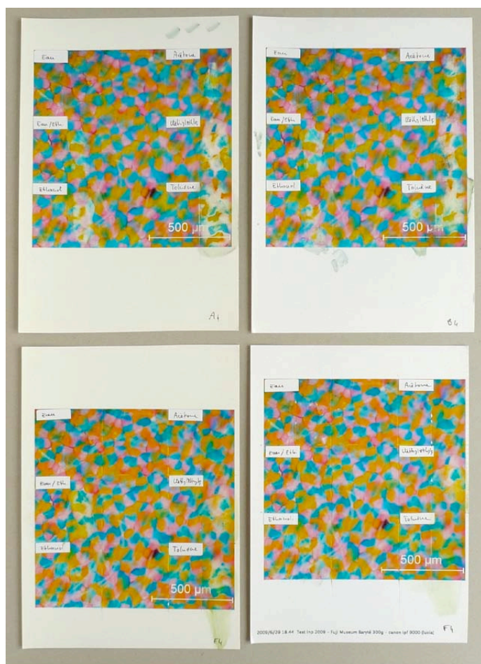
Illustration 23 : résultats des tests de solvants sur les tirages jet d'encre pigmentaire sur papiers barytés. (photo F. Ploye)
