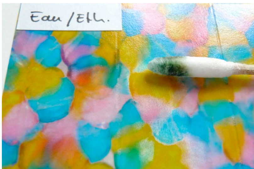
Illustration 17 : effet du mélange eau/éthanol + frottement sur un papier baryté (perte de couleur visible sur le bâtonnet de coton et sur le tirage). (photo F. Ploye)
