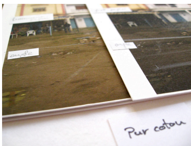
III. 12 : Tests 2008, marques d'ongles sur la surface de tirages jet d'encre pigmentaire sur papier pur coton. Tous les types de papiers testés « marquent » à l'ongle.
