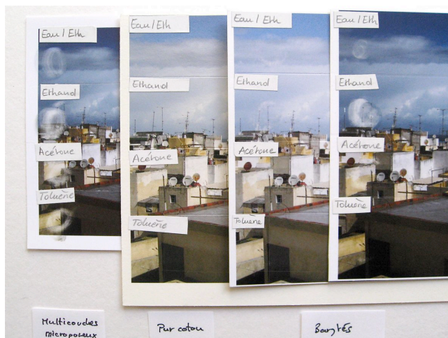
III. 10 : Tests 2008, exemple de réactions de solvants sur quatre échantillons. Même encre pigmentaire sur différents papiers, de gauche à droite : un papier RC multicouche, un papier pur coton puis deux papiers barytés.
