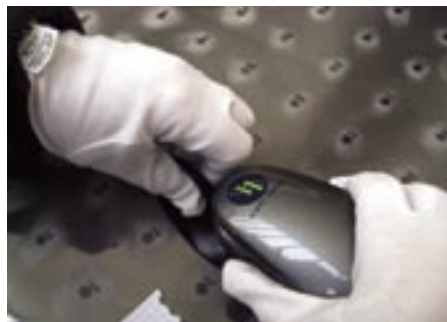
Fig. 4. Positionnement du colorimètre sur la matrice permettant de faire des mesures répétées sur un même point. ©ARCP/Fmac.
